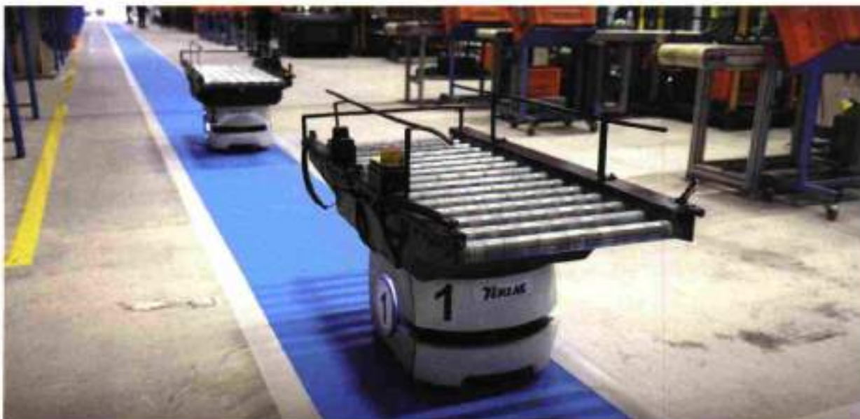
I robot mobili di Omron prelevano i prodotti in arrivo, li caricano su un trasportatore tramite un braccio robotico e li distribuiscono automaticamente nelle posizioni designate all'interno delle celle.
